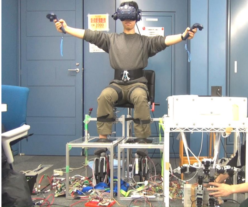
図4 小型人型ロボット安定操縦実験
